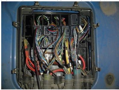
6 шаг. Основной модуль устройство устанавливается на внутренней стороне кабины. В кабине нужно снять нижнюю крышку передней панели на правой стороне:
