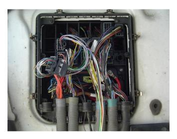
4 шаг. Отключить разъем в шестом столбике с левой стороны машины (отмечен X 6) и во второй линии от верхней части:
