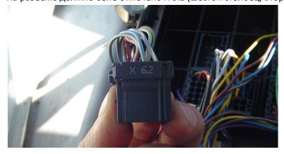
5 шаг. Между этими разъемами подключается разъемы жгута: один разъем подключается к гнезду, который остался в панели разъемов кабины / шасси во втором ряде от верхней части и шестом столбце от левой стороны, второй соединитель ставится в свободное место коробки соединений кабины-шасси. Разъем должен быть вставлен так что провода разъема от разъема шли в сторону
