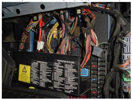
На этой стороне смонтировать устройство, один разъем с передней части автомобиля, протолкнув его через отверстие, а другой разъем вставить его в свободное место во втором ряду (коробку соединителей кабины-шасси использовать в качестве держателя соединителей).
