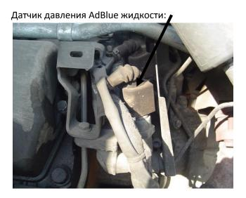
9 шаг. Блокируем каналы насоса AdBlue так, чтобы не протекла Adblue жидкость:
