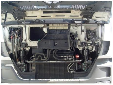
3 шаг. Открыть панель разъемов кабины / шасси (распределительный щит проводов).
