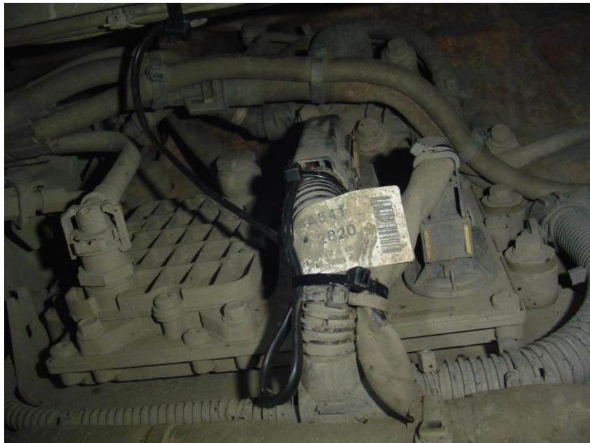
Датчик давления AdBlue жидкости:
