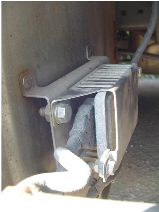
**Внимание!!!! Никогда не оставляйте оригинальный датчик NOX подключенным если используете метод параллельной установки !!!**
