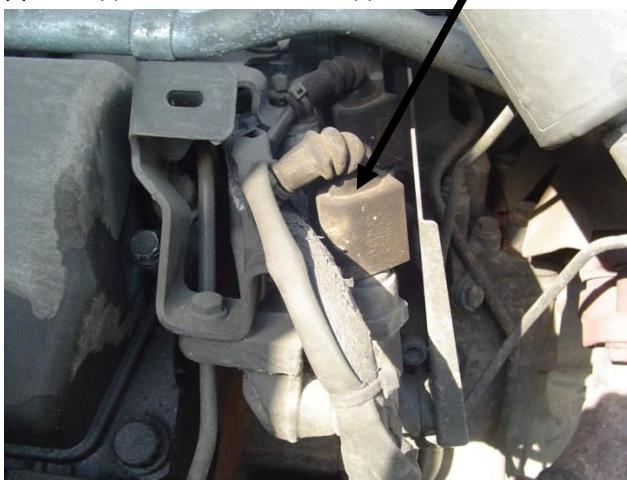
7 шаг. Блокируем каналы насоса AdBlue так, чтобы не протекла Adblue жидкость:
